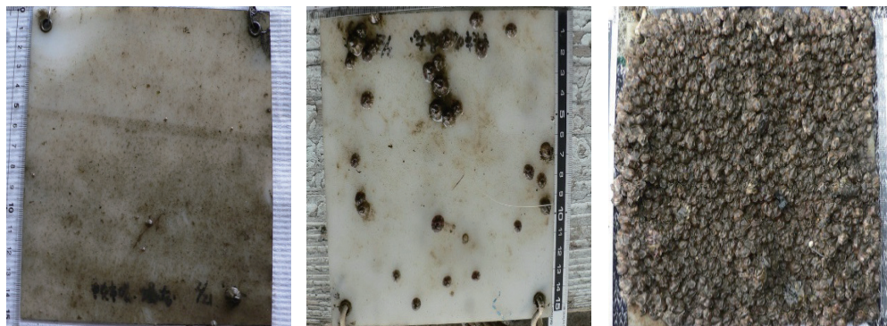
図14 兵庫運河に垂下した試験板への付着状況(左から7/7 8/8 10/5)
